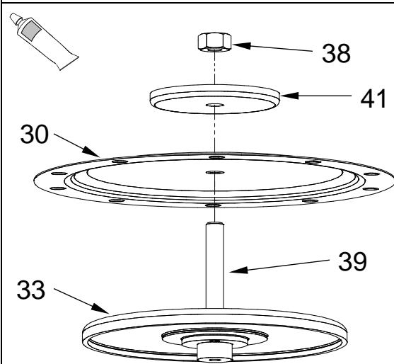
4. Schrauben (39), Membranteller (41), Membrane (30) und Membranscheibe (33) mit Mutter (38) fest verschrauben.
