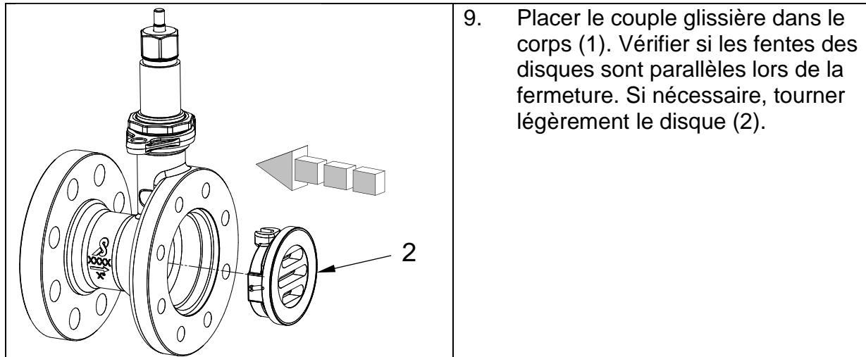
9. Placer le couple glissière dans le corps (1). Vérifier si les fentes des disques sont parallèles lors de la fermeture. Si nécessaire, tourner légèrement le disque (2).
