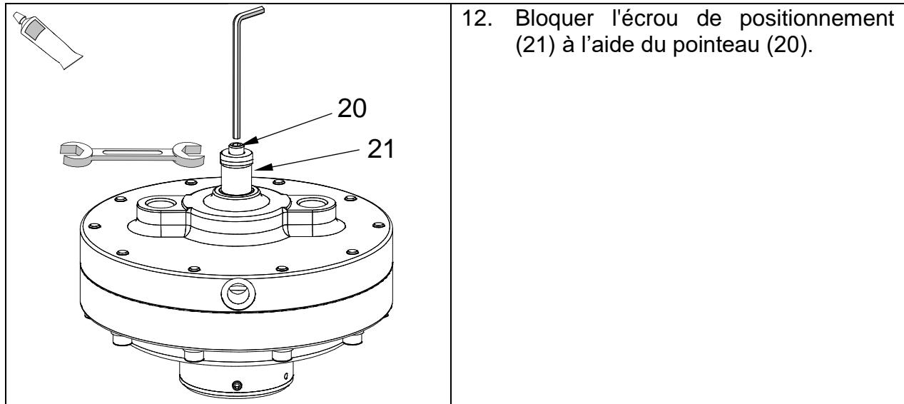
12. Bloquer l'écrou de positionnement (21) à l'aide du pointeau (20).
