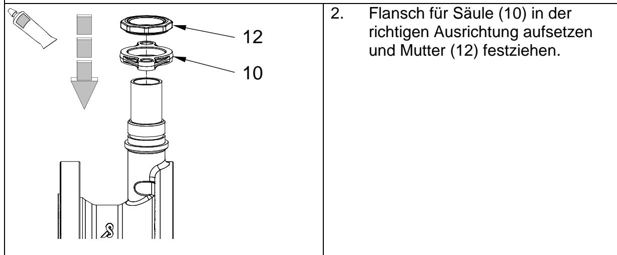
2. Flansch für Säule (10) in der richtigen Ausrichtung aufsetzen und Mutter (12) festziehen.
