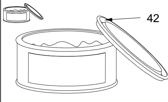
3. Dichtung (42) einsetzen.
